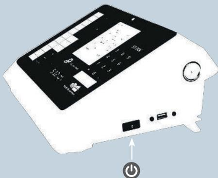
Appuyez sur le bouton situé sur le côté de l'appareil pour allumer le Smart, puis patientez jusqu'au chargement complet.
